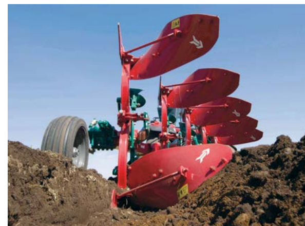
профиль борозды отвала № 28 рабочая глубина: 26 см, дно: 30 см, ширина 73 см.
