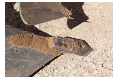
Поток почвы защищает другие части
